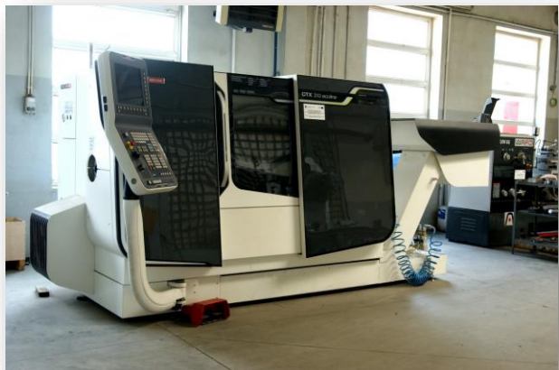
Токарный станок CTX 310 есо с ЧПУ Siemens 840 D SL
